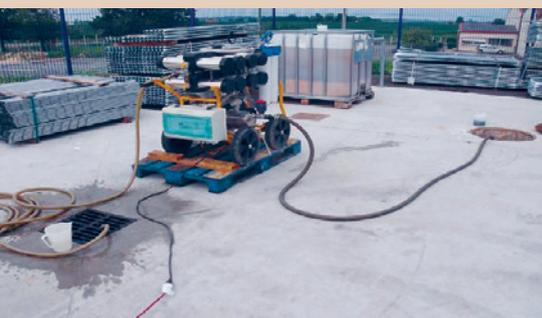
Un impianto di ultrafiltrazione permette di trattare grandi quantità di acqua, CCD
