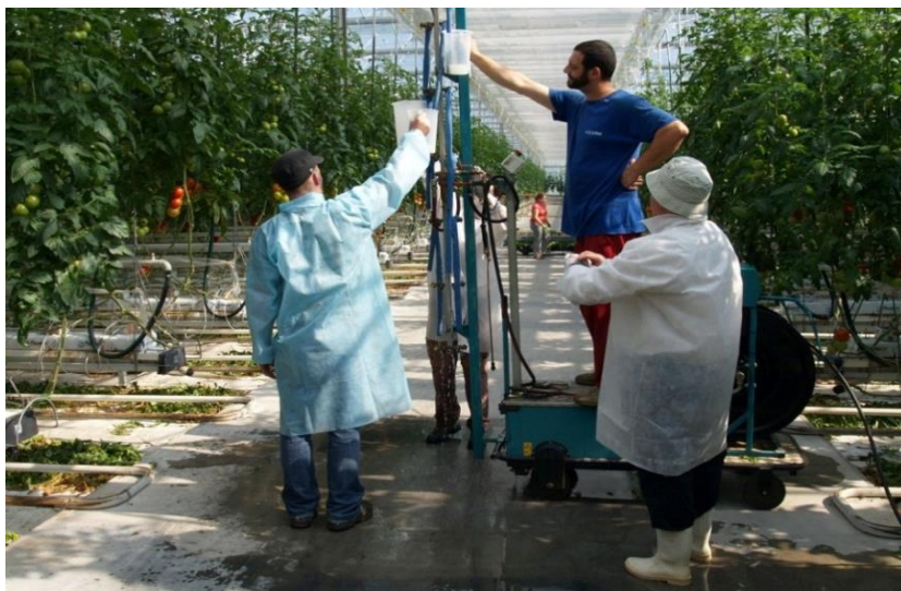
Foto 1: misurazione del flusso per ugello e minuto (foto J. Rüegg)
