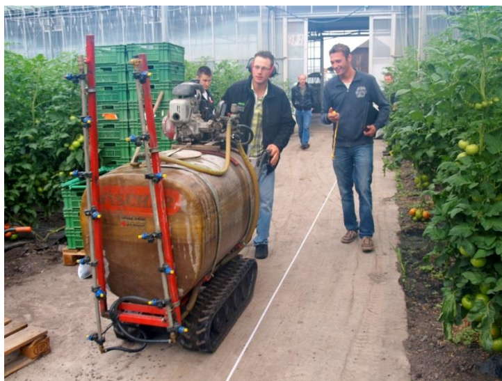
Foto 2: il tempo d'avanzamento dell'irroratrice per percorrere una distanza di 30-50 metri (corda metrica) viene determinato con un cronometro (foto J. Rüegg).
